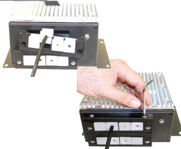
Mit der noch fehlenden oberen Abdeckung wird die Kabeldurchführung verschlossen und diese an den FlatMan BOXPC angeschraubt.
